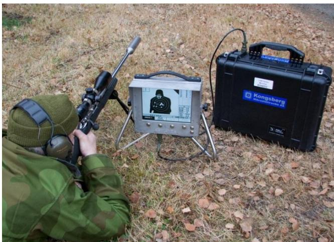
**Monitor basert på LCD teknologi med LED baklys, designet for allværs / helårs bruk. Ikke behov for overbygd standplass**
